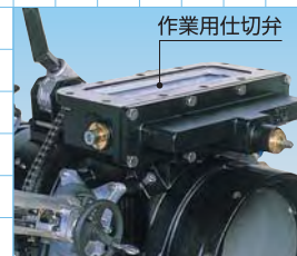
作業用仕切弁
